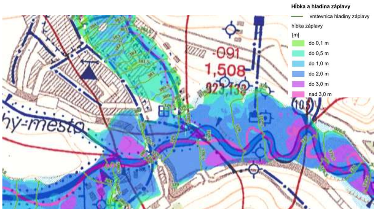
Obr. 3 Ukážka mapy povodňového ohrozenia v obci Spišské Vlaky (hĺbka (m) a hladina (m n.m.) záplavy)
